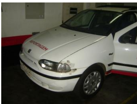
Foto 5 - Lanterna afixada com fita adesiva
