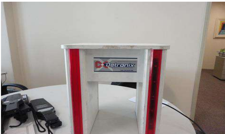
Fotos 23 – Detector de metal – tipo banqueta apresentada durante inspeção na CGME/DAL – marca Detronix
